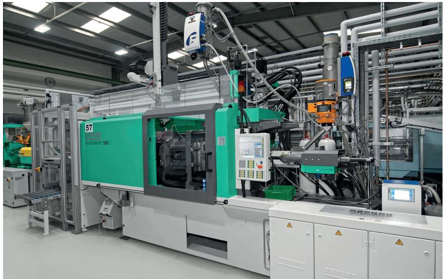
Bild 3. Die filigranen Cantilever entstehen auf einer 2K-Spritzgießmaschine Allrounder 520 S im Montage-Spritzgießverfahren. © Arburg
